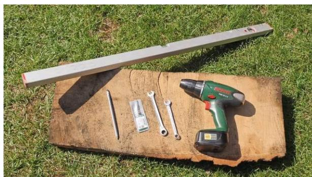
Per il montaggio è necessario un **cacciavite a batteria** con **punta in metallo di 4,2mm e cacciavite a croce (PH2)**.
